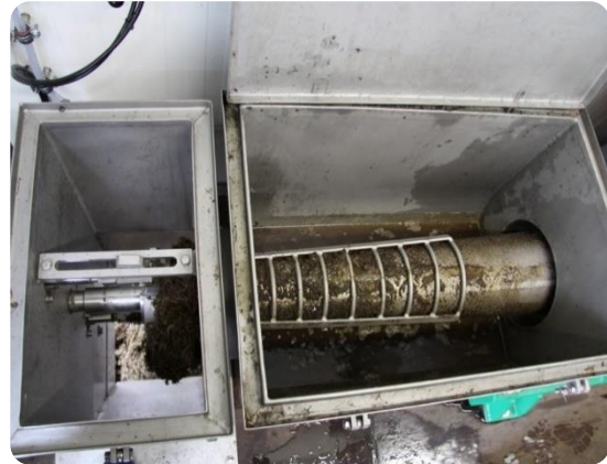
Abbildung 4: mechanische Entwässerung von Restbiomassen im IFBB-Technikkonzept
