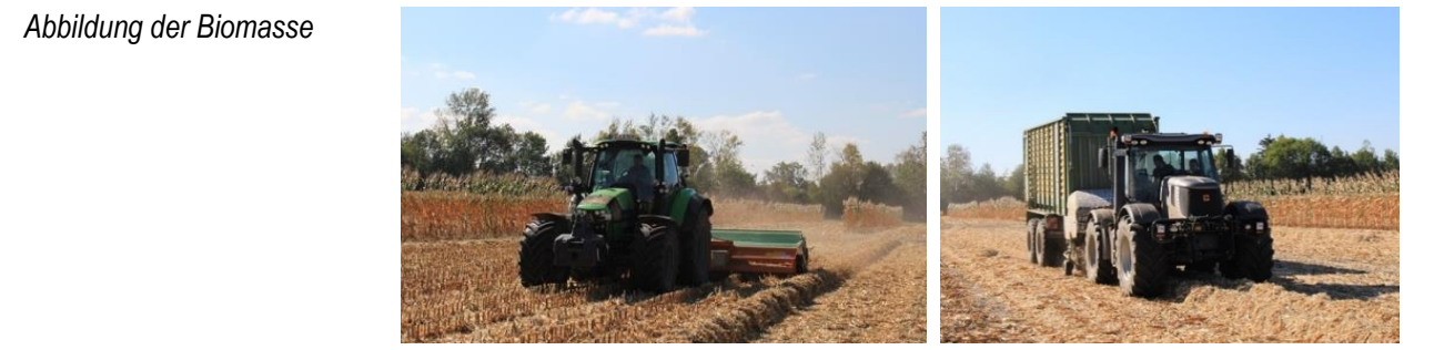
Fotos 1: Häckseln und Schwaden mit dem Schwadhäcksler BioChipper (Quelle: Lfl Bayern) Foto 2: Aufnahme mit dem Kurzschnittladewagen (Quelle: Lfl Bayern)
