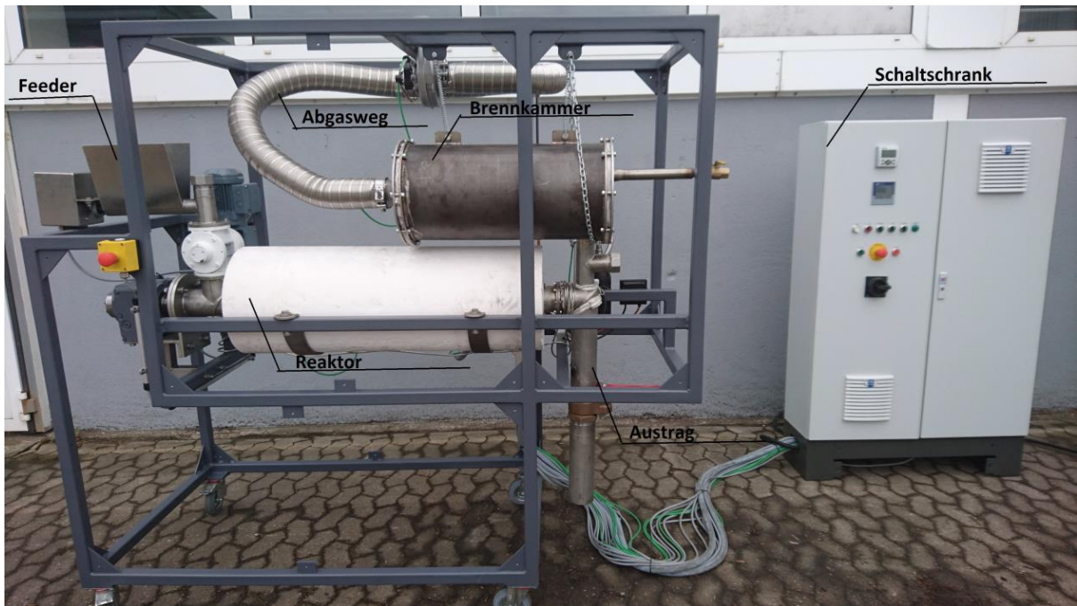
Abbildung 5: Pyrolyse und Aktivierung mittels Laboranlage „Pyreka“ (Bild: Jens Heberling, Pyreg)
