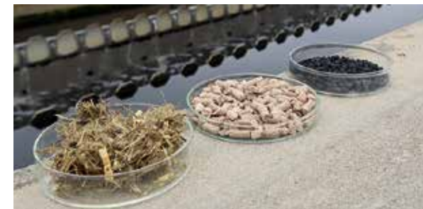
Im CoAct-Projekt wird Aktivkohle aus Reststoffen hergestellt und zur Abwasseraufbereitung eingesetzt.
