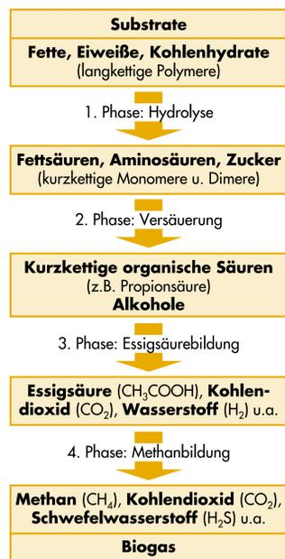
Biogas besteht im Wesentlichen aus Methan CH<sub>4</sub> (50-75%) und Kohlendioxid CO<sub>2</sub> (25-45%) und entsteht durch Vergärung pflanzlicher oder tierischer Stoffe.
